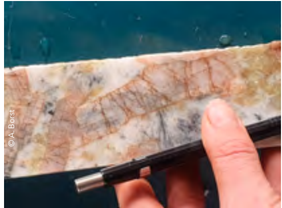
Staal van een spodumeen (lithiumerts) rijk pegmatiet van Piran Rwanda Ltd, werkzaam in de regio Musha en Ntunga, in Rwanda.
