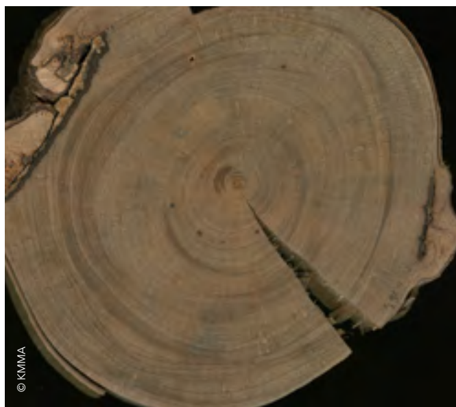
Het SmartWoodID-project stelt een databank samen met beeldmateriaal van Congolese stalen uit het xylarium in Tervuren. Deze beelden worden gebruikt om hout te identificeren op basis van macroscopische kenmerken met behulp van artificiële intelligentie. Op de foto: Pioria balsamifera (tola).
